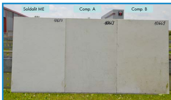
Figura 84: Comparativa de autolimpieza de pintura fotocatalítica con convencionales tras 5 años de exposición a intemperie. Fuente: KEIM.
