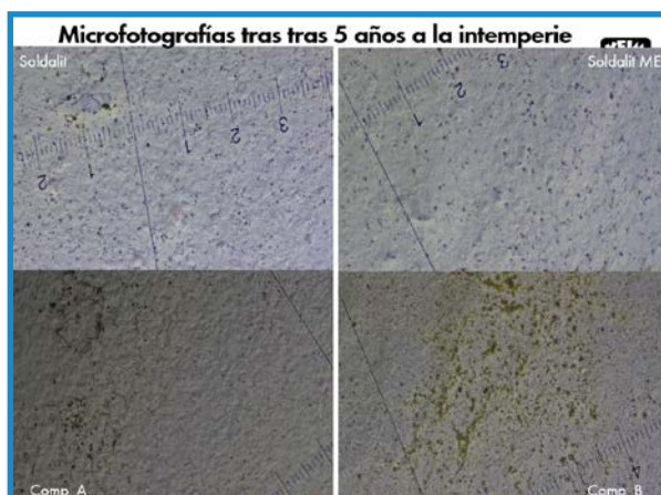
Figura 85: Comparativa de microfotografías tomadas sobre los paneles tratados y no tratados con fotocatalisis, tras 5 años de exposición a intemperie. Fuente: KEIM.
